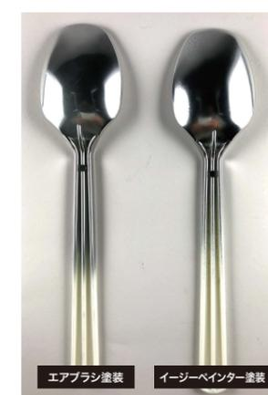
左がエアブラシ塗装したもの、右がイージーペインターで塗装したもの。圧が強い分荒くなり、塗膜のコントロールが難しくなります。
