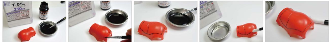
ブラックの塗料をエナメル系溶剤で薄めます。塗装する場合よりも溶剤で薄めます。
